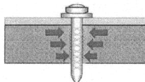
При заходе дюбеля в стальное основание, благодаря эластичности металла, возникает давление на стержень дюбеля, удерживающее его в отверстии, а так же появляются силы сцепления благодаря диффузионному схватыванию и привариванию его к металлу основания.
