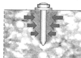
Дюбель входит в бетон, частично вытесняет его и уплотняет вокруг себя, создавая напряжение. Кроме того, сила трения при входе дюбеля создает тепло (температура доходит до 900°С), благодаря которому происходит схватывание дюбеля и бетона.
